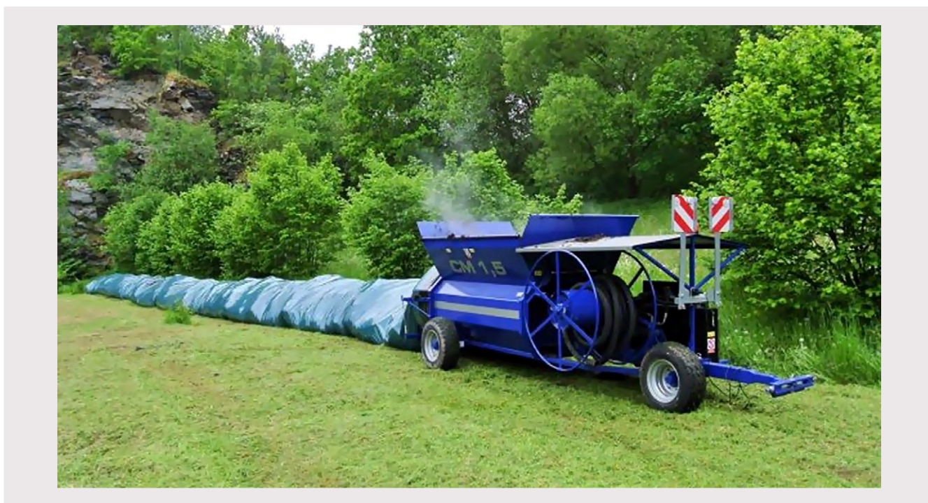
Obrázok 23: Kompostovanie vo vaku, technológia spoločnosti Euro bagging, s. r. o. (zdroj: https://www.eurobagging.com/cs/kompostovaci-technologie )
